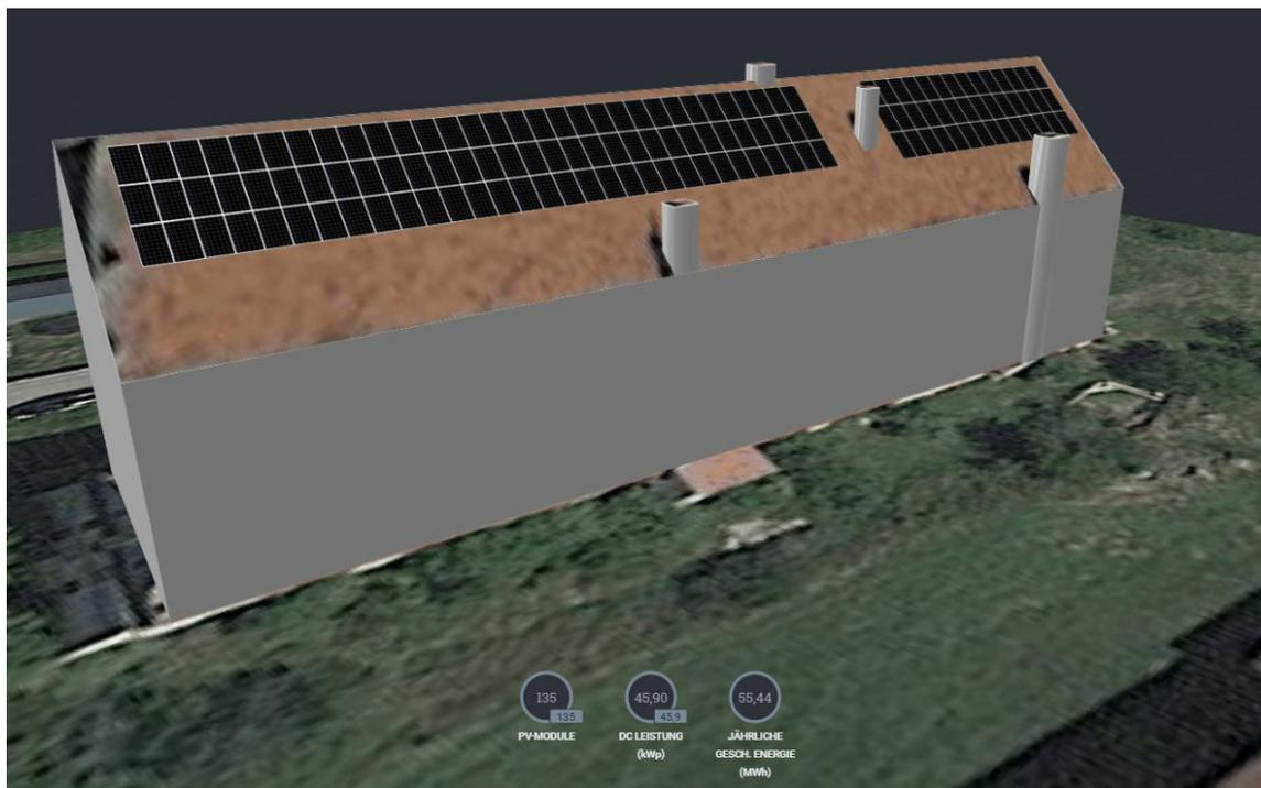
Die Dachfläche nach Süden / Richtung Heizkraftwerk und Biogasanlage sollte mit Solarpanellen für Stromgewinnung und Sicherung gegen Sturmschäden abgedeckt und 8 Dachflächenfenster eingebaut werden.
